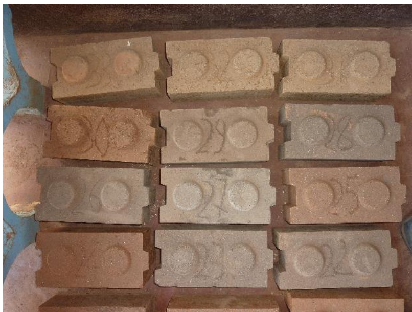
foto 17, test su numerosi tipi di terra
