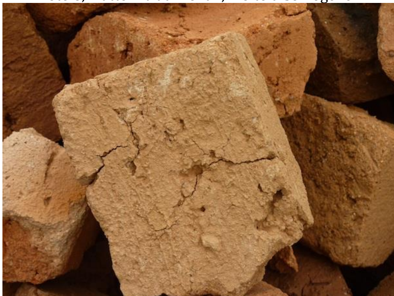
Foto 7, Mattoni tradizionali fratturati ed irregolari
