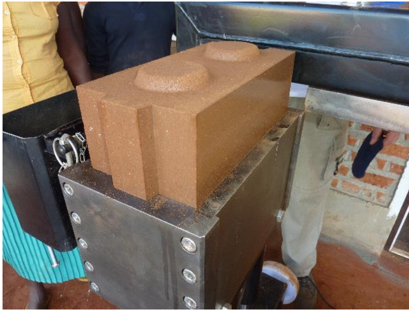
Foto 2, il blocco in terra cruda pressata "Mattone"
