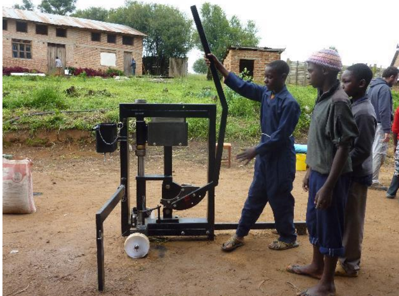
Foto 14 pressatura manuale bidirezionale, tramite azionamento a leva
