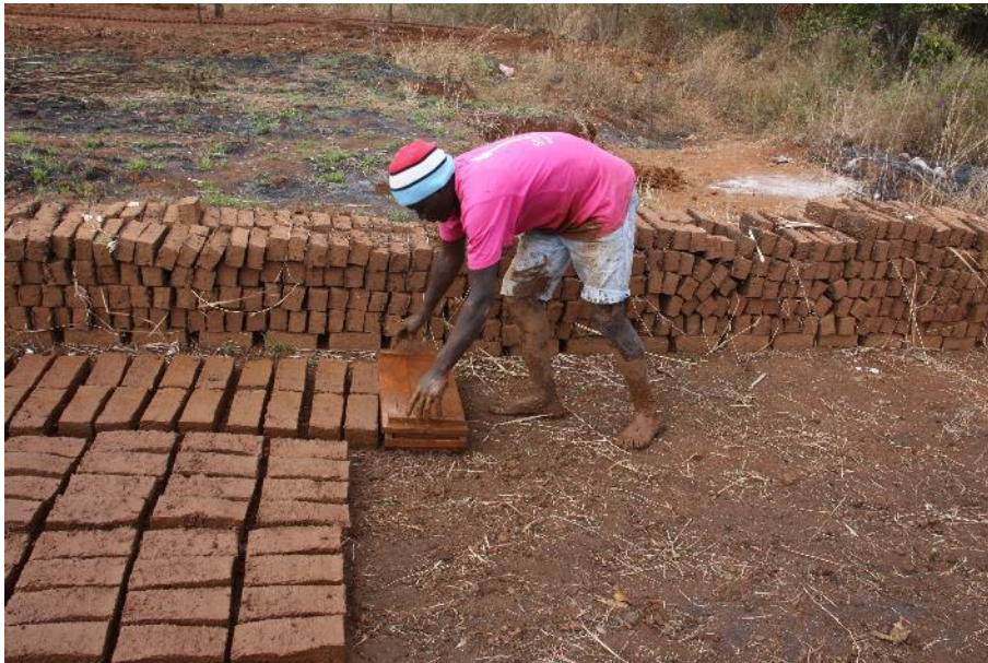
Foto 4 la produzione di mattoni tradizionali in Tanzania, essiccazione al sole
