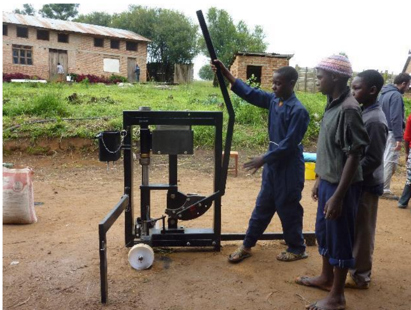
foto 1, pressa per la realizzazione di mattoni in terra cruda pressata
