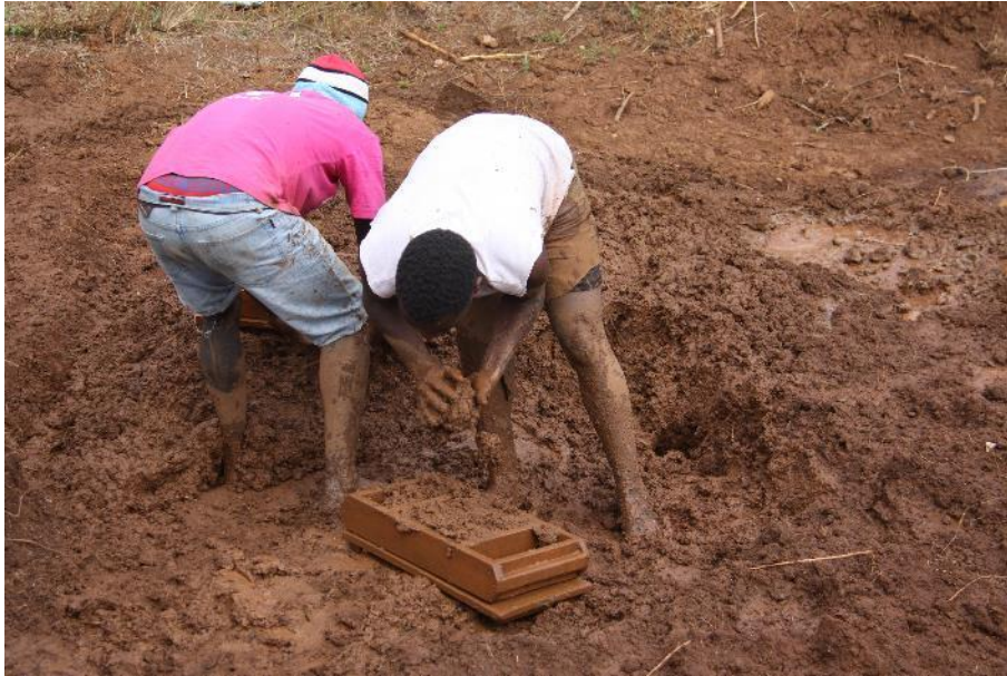
Foto 3 la produzione di mattoni tradizionali in Tanzania, riempimento stampi
