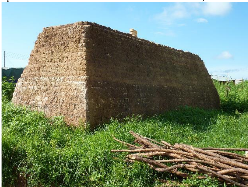
Foto 4 la produzione di mattoni tradizionali in Tanzania, essiccazione al sole
